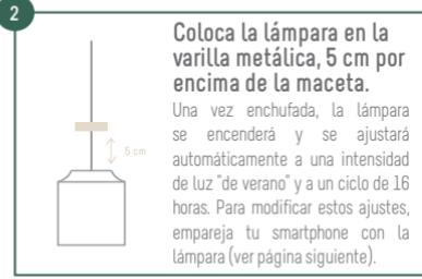
Coloca la lámpara en la varilla metálica, 5 cm por encima de la maceta.
